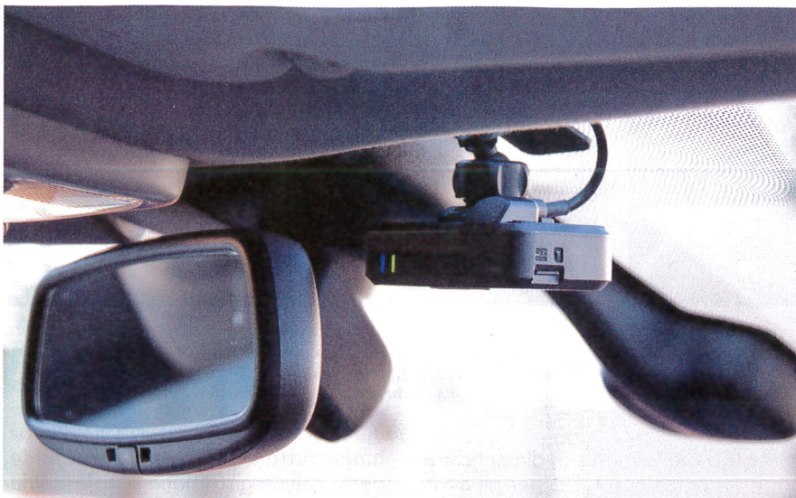
La dashcam installata nella parte alta del parabrezza. Non è facile come sembra trovare la posizione ottimale per l'installazione della dashcam. C'è da combattere con sensori sul parabrezza che ostacolano la visuale, come nel mio caso, con parabrezza molto inclinati, come nel mio caso, con problematiche di visibilità dall'esterno e le inevitabili complicazioni di cablaggio.
